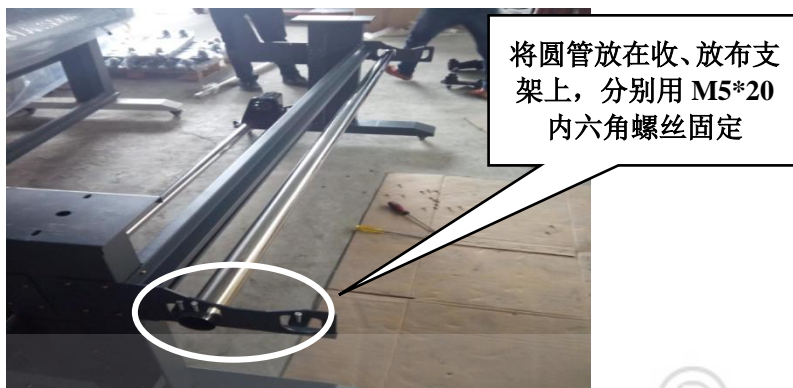
图 1.13 圆管安装示意图（三）
