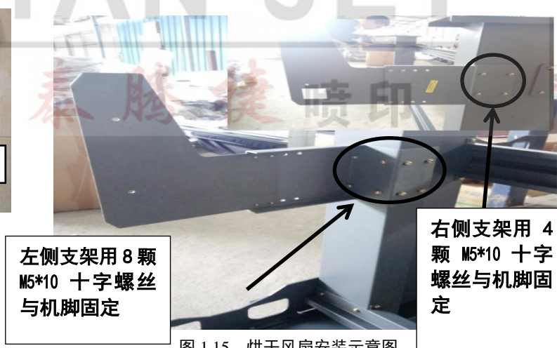
图 1.15 烘干风扇安装示意图
