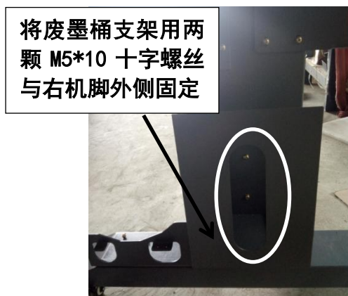
图 1.16 废墨桶支架安装示意图
