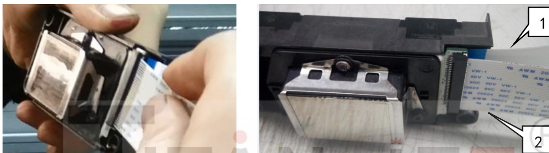
图 5.2 喷头数据线连接
