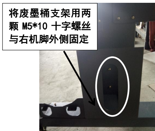
图 1.16 废墨桶支架安装示意图
