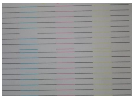
图 8.12 水平喷头对齐测试条
