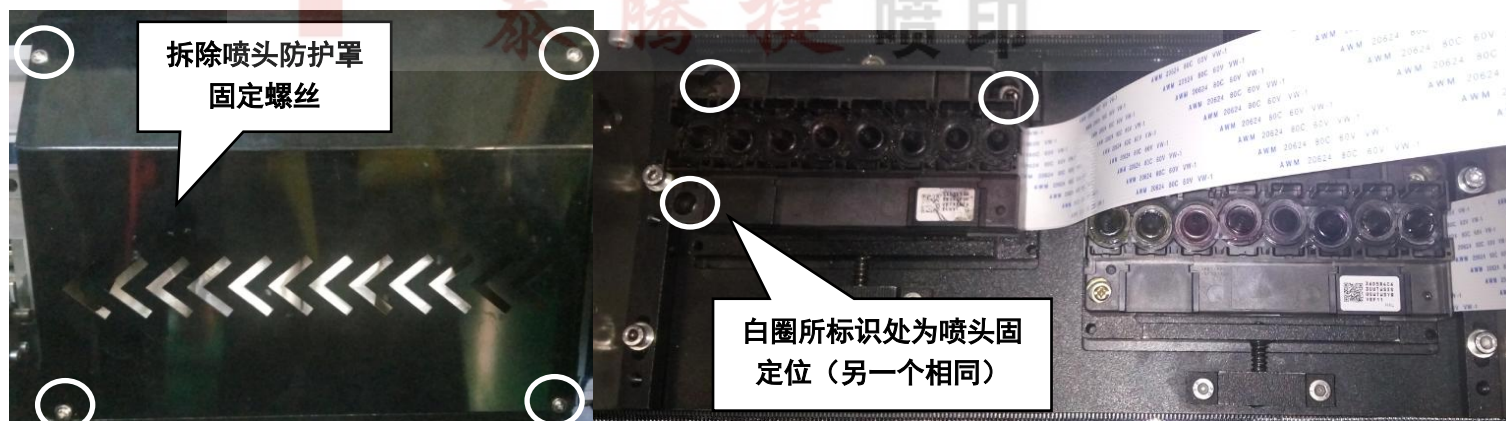
图 5.3 喷头固定位示意图
