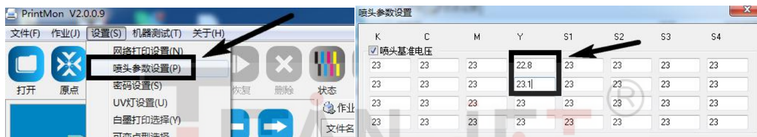
图 3.57 填入 Y 对应的喷头电压
