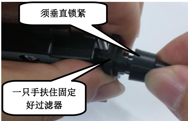
图 3.16 安装排气管（三）
