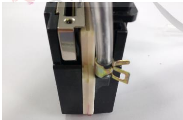
图 3.21 安装水循环管路（四）
