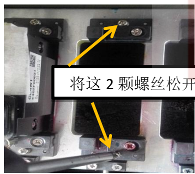
图 3.28 安装墨管和喷头（三）
