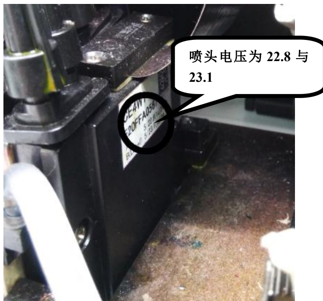
图 3.56 Y 对应的喷头电压
