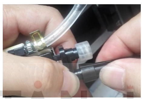
图 3.27 安装墨管和喷头（二）
