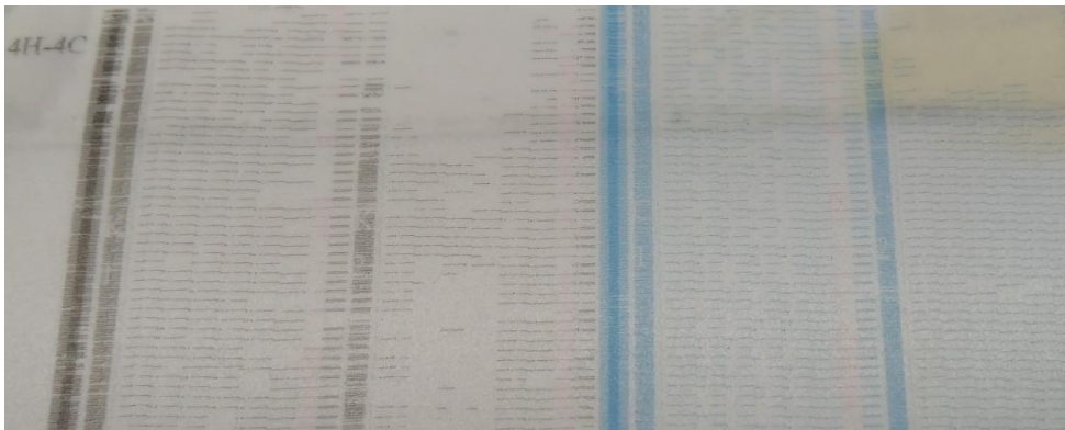
图 3.35 喷头欠佳时的测试条
