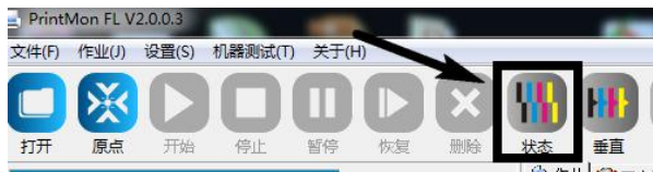
图 3.34 喷头状态测试
