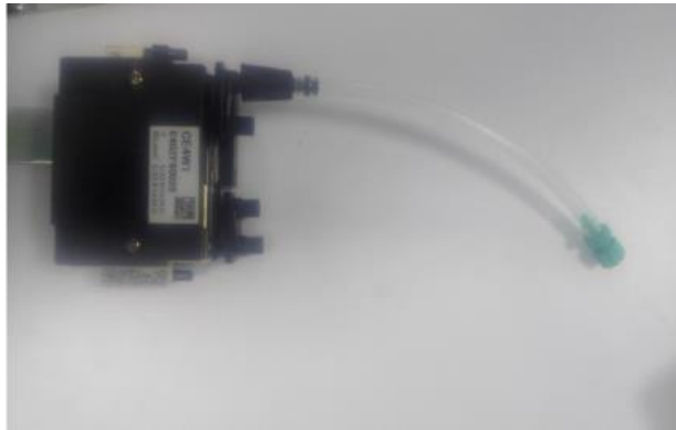
图 3.17 安装排气管（四）
